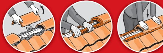
Κόλλημα κεραμιδίων ή τεμαχίων κεραμιδίων στο κοίλωμα της τομῆς δύο επιφαυειών στέγης
